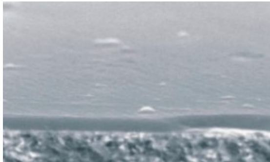
Bild 1 Bruchfläche einer DLC-beschichteten Hartmetallprobe, V = 3000:1
