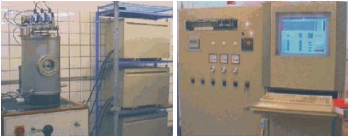
Rezipient mit Gasversorgung, Stromversorgungen (li.), Steuerschrank und Prozess-Visualisierung (re.) der umgerüsteten Vakuumanlage zur filamentaktivierten CVD-Diamantabscheidung
