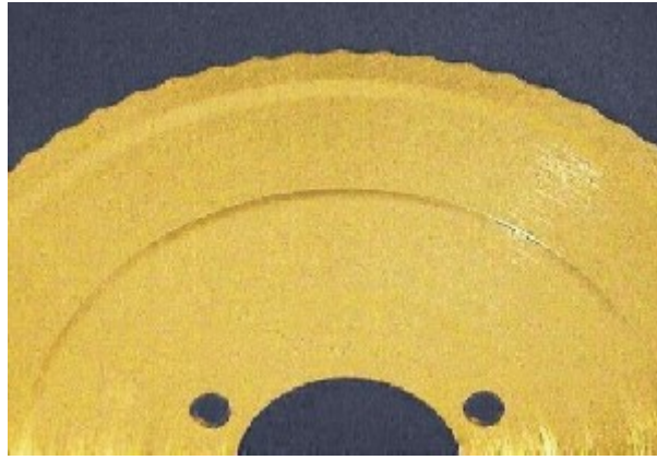
Abb. 5: TiN-beschichtetes Rundmesser mit chemisch abgeschiedener NiP-Zwischenschicht nach 15 Spülgängen
