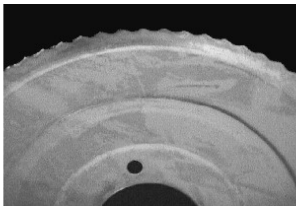
Abb. 2: Typische Schattierung von chem. NiP-beschichteten Rundmessern nach dem 15. Spülgang
