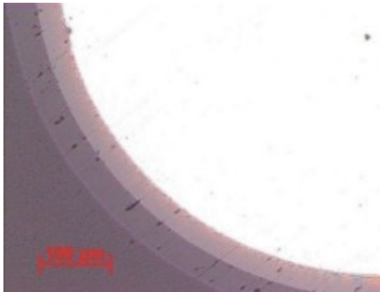
Bild 1: Amorphe, aus Komponenten des Elementsystems C-B-Si bestehende Hartstoff-/Schmierstoff-Kombischicht
