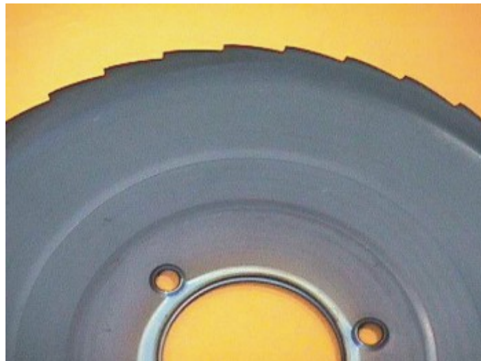
Bild 4: Rundmesser für Allesschneider mit versuchsweiser a-(C,B,Si) -Beschichtung
