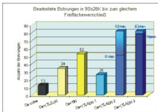
Bild 9 Leistungsfähigkeit von Cermet-Reibahlen ohne und mit Beschichtung, Abbruchkriterium Verschleißmarkenbreite 0,1 mm, Schnittbed. vc=50 m/min, fz=0,3 mm/U, Kühlmittel
