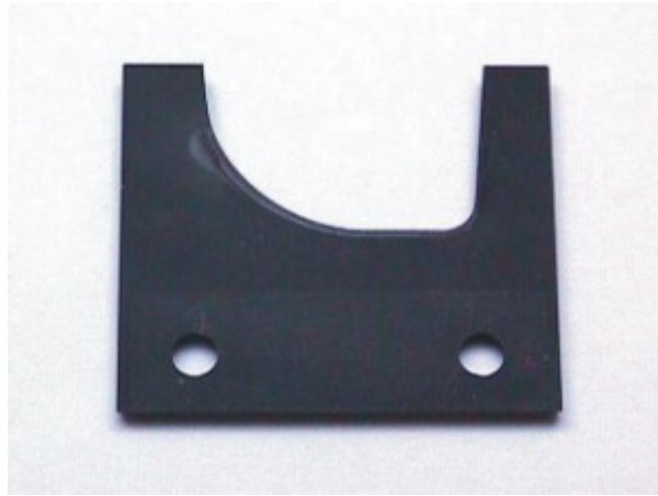
Bild 1: Vollflächig mikrokristallin CVD-diamantbeschichtete Hartmetall-Fräsplatte für die Profilierung von MDF-Platten nach der Praxiserprobung mit Verschleißmarke an der Schneidkante
