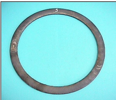
Formschweißteil und endbearbeitetes Kreismesser
